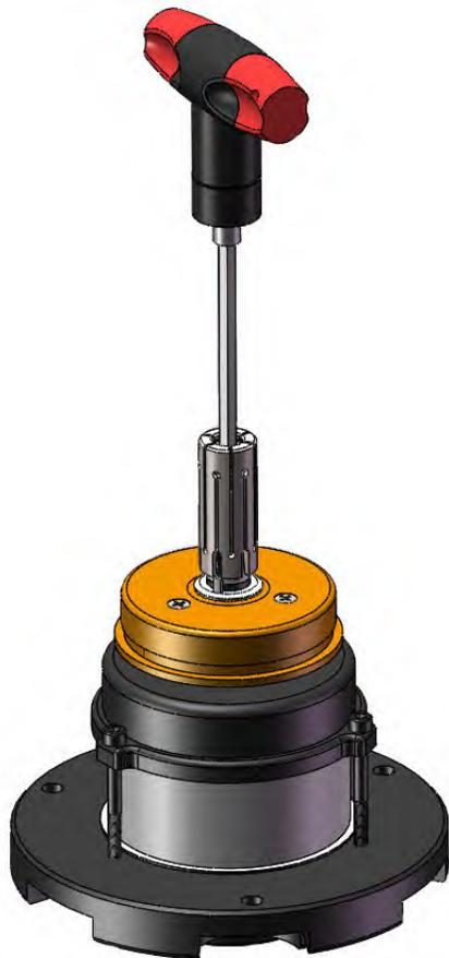
注释 当弹簧夹头缺口与电机环凸台逐渐接近时，必须保证电机环凸台对准卡入弹簧夹头缺口。
