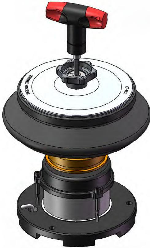
注释 角转子盖逆时针旋转为松盖，顺时针旋转为拧紧。
