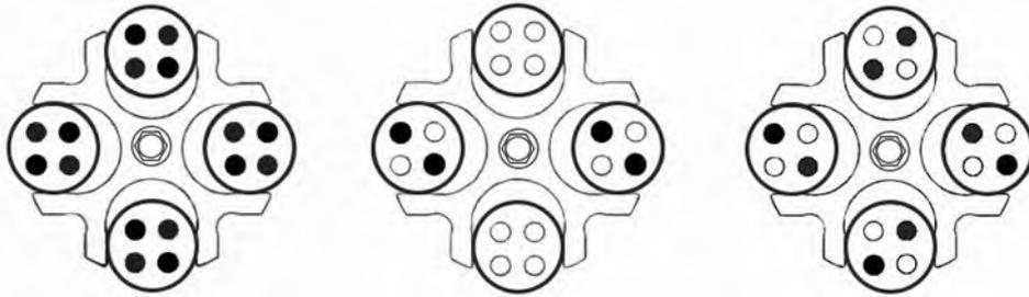
图 A.6 水平转子错误装载
