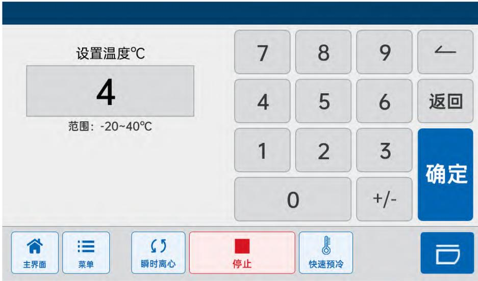
1. 零上温度设置：使用数字键盘，输入需要的数值，按确定按钮确认设置；或按返回按钮取消设置并返回上一级界面。
